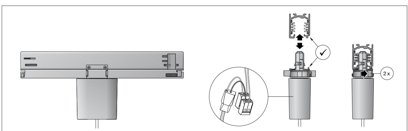
Stromschienenaadapter mit Pendelleuchte an der gewünschten Position in die Stromschiene einsetzen.
