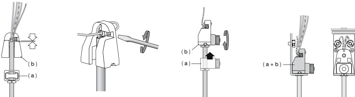
**WICHTIG:** Achten Sie darauf, dass bei der Zugentlastung keine stromführenden Leitungsdänen zwischen Stahlseil und Messingbuchse eingeklemmt werden.
