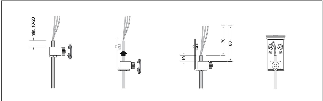
Zur Feineinstellung der Abhängehöhe, Rändelmutter lösen, Leitungslänge justieren und Rändelmutter wieder festdrehen.
