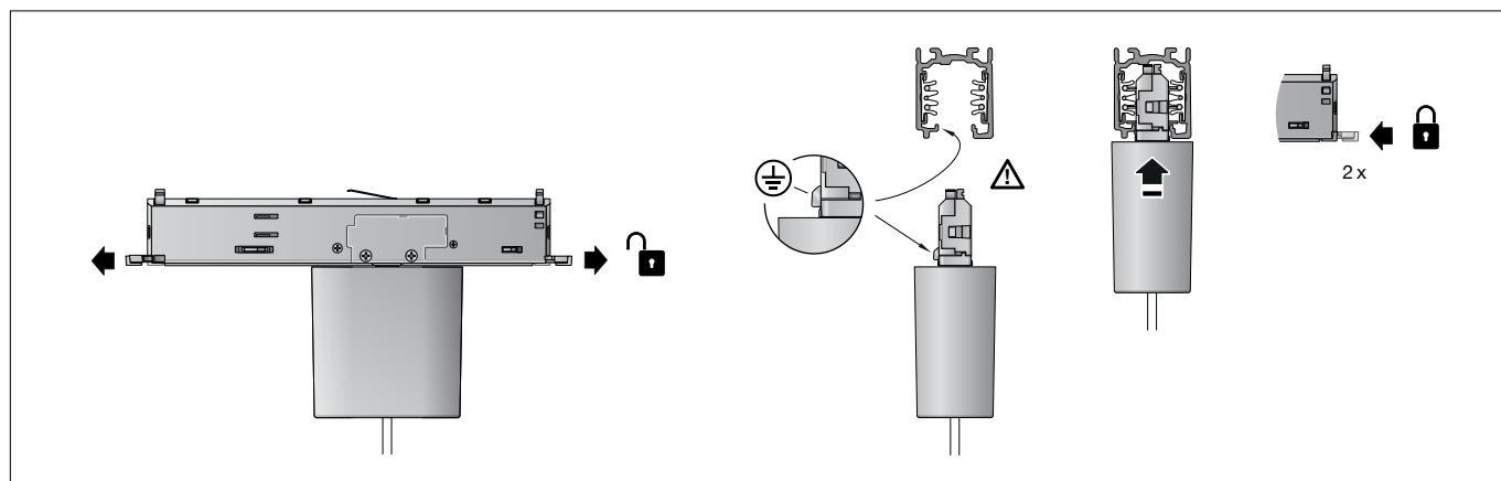
Stromschiienenadapter mit Pendelleuchte an der gewünschten Position in die Stromschiene einsetzen.
