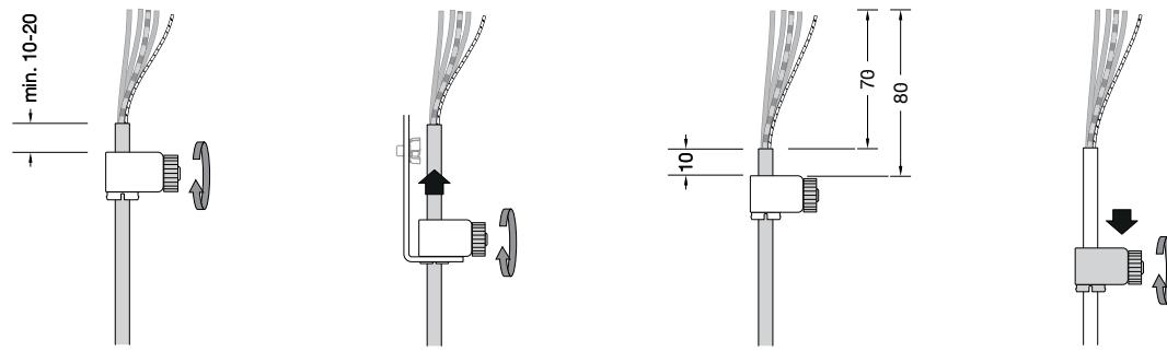
Zur Feineinstellung der Abhängehöhe, Rändelmutter lösen, Leitungslänge justieren und Rändelmutter wieder festdrehen.
