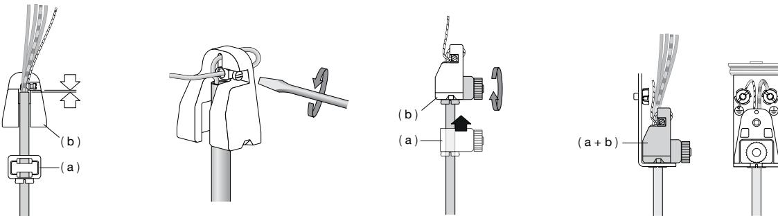
**WICHTIG:** Achten Sie darauf, dass bei der Zugentlastung keine stromführenden Leitungssadern zwischen Stahlseil und Messingbuchse eingeklemmt werden.
