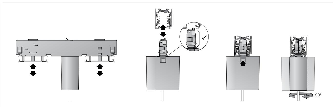
Stromschienenadapter mit Pendelleuchte an der gewünschten Position in die Stromschiene einsetzen.
