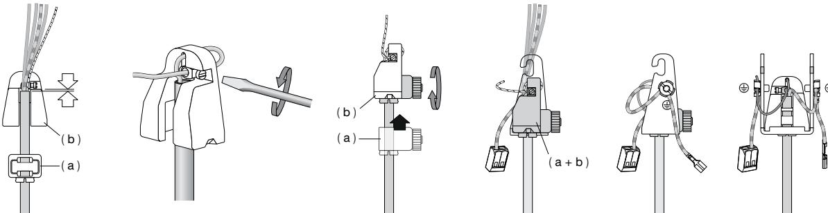
**WICHTIG:** Achten Sie darauf, dass bei der Zugentlastung keine stromführenden Leitungsdänen zwischen Stahlseil und Messingbuchse eingeklemmt werden.
