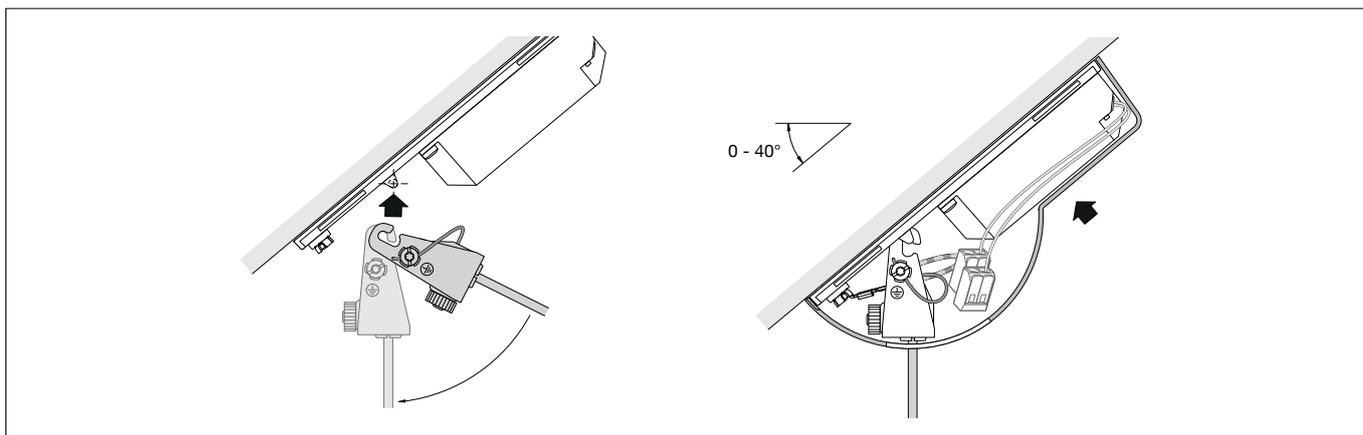
Schutzleiterverbindung zwischen Leuchtaufhänger und Montageplatte (Steckverbindung) herstellen. Anschlussader **rot** auf „+“ und Anschlussader **schwarz** auf „-“ auf den gekennzeichneten Klemmen anschließen.
