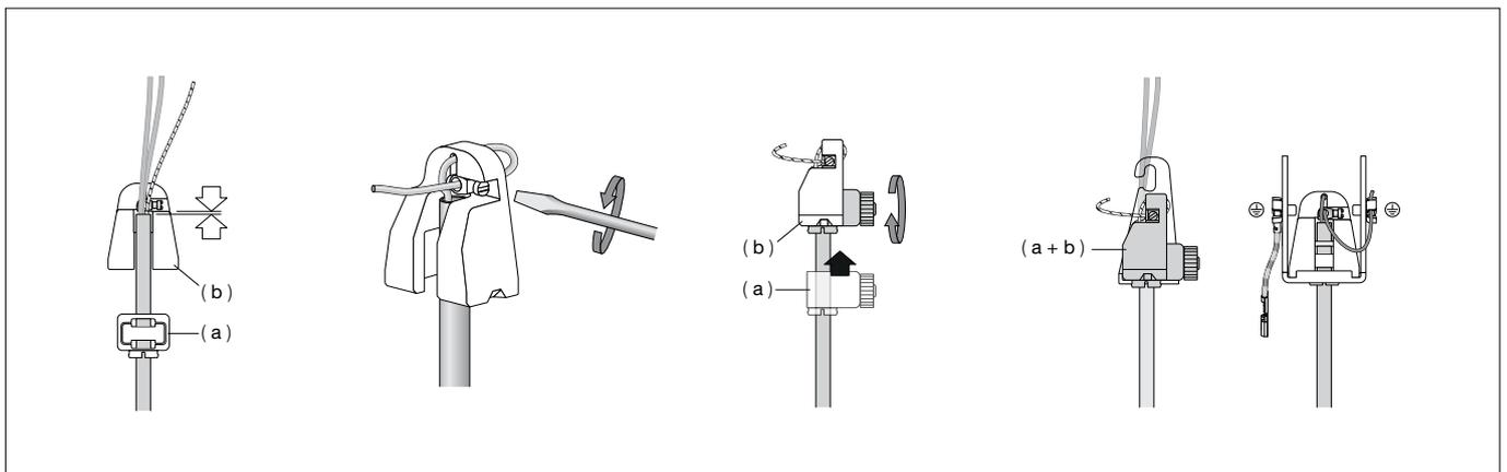
**WICHTIG: Achten Sie darauf, dass bei der Zugentlastung keine stromführenden Leitungsadern zwischen Stahlseil und Messingbuchse eingeklemmt werden.**
