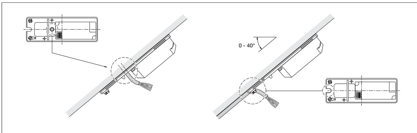
Netzanschlussleitung durch Montageplatte führen.
