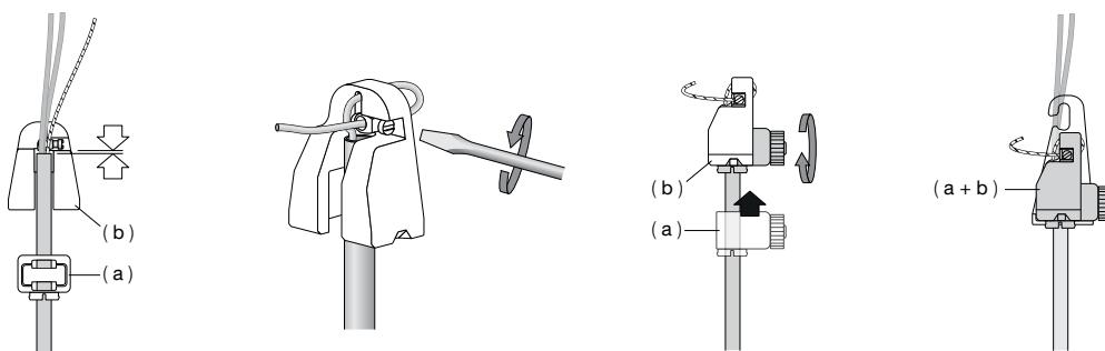
**WICHTIG:** Achten Sie darauf, dass bei der Zugentlastung keine stromführenden Leitungsdänen zwischen Stahlseil und Messingbuchse eingeklemmt werden.
