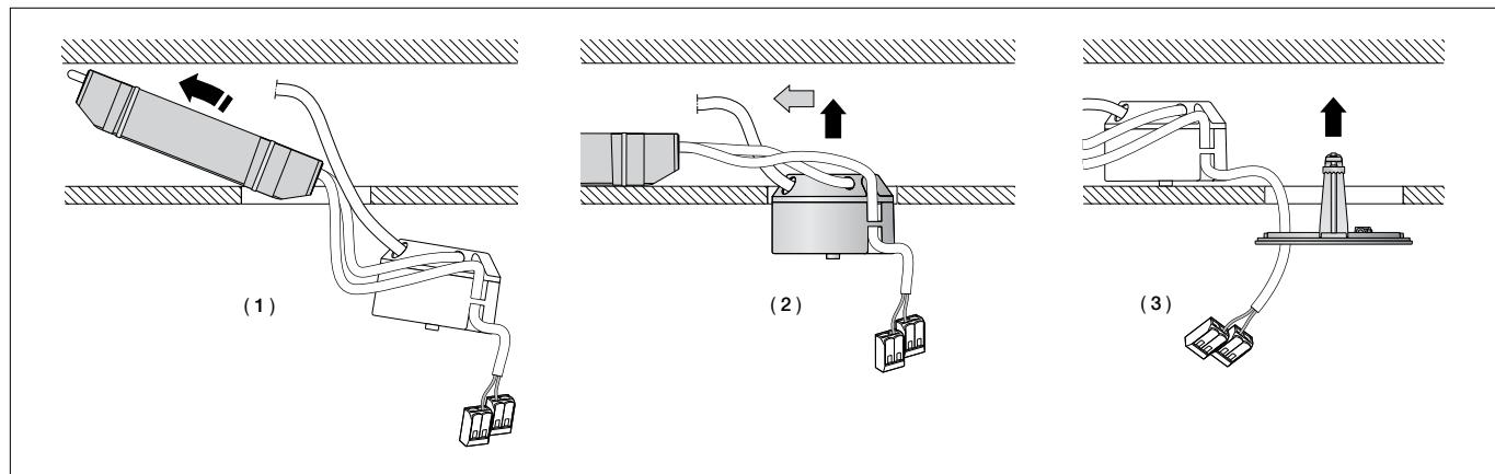
Externes Netzteil in die Einbauöffnung der abgehängten Decke schieben – siehe Skizze (1).
