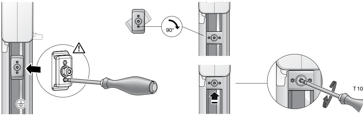
Die Spitze eines Torx-Schraubendrehers (T10) in eine der beiden sternförmigen Vertiefungen seitlich der Torschraube stecken und Adapterstop senkrecht in die Stromschiene einführen.
