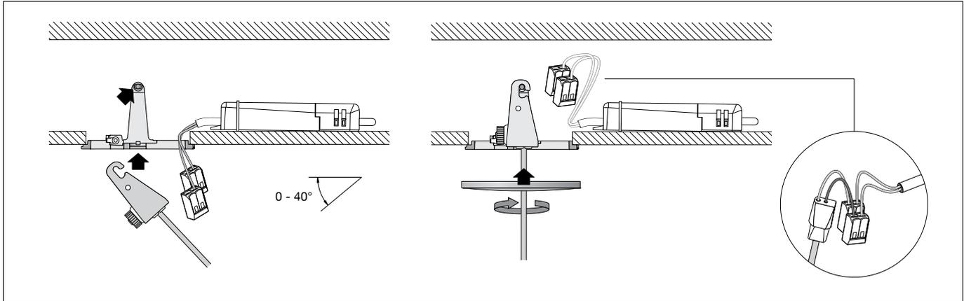
Anschlussader **rot** auf „+“ und Anschlussader **schwarz** auf „-“ auf den gekennzeichneten Klemmen anschließen.
