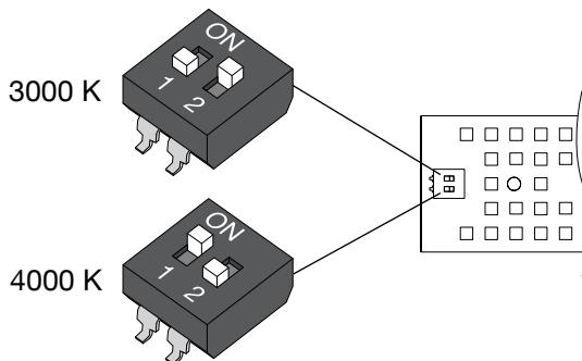
Die Farbtemperatur des LED-Moduls wurde werkseitig auf 3000 K eingestellt (Schalterstellung 1: "off", 2: "on"). Für Farbtemperatur 4000 K muss die Schalterstellung 1: "on" und 2: "off" gewählt werden.
