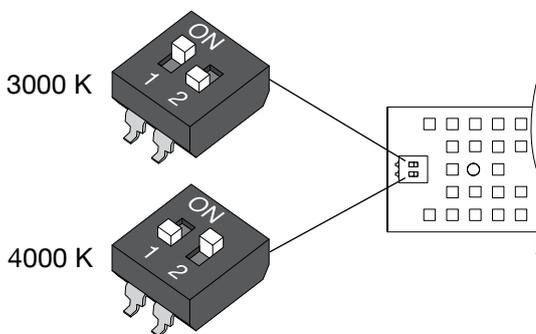
Die Farbtemperatur des LED-Moduls wurde werkseitig auf 3000 K eingestellt (Schalterstellung 1: "on", 2: "off"). Für Farbtemperatur 4000 K muss die Schalterstellung 1: "off" und 2: "on" gewählt werden.
