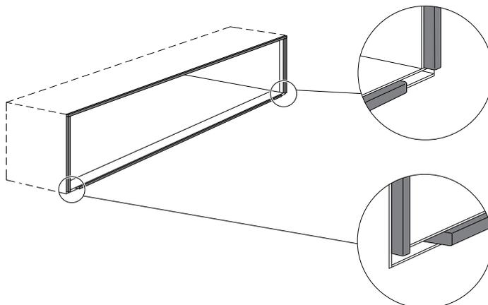
**Einbau in senkrechter Brennlage · Installation in vertical mounting position · Installation en position verticale**
