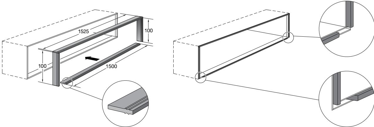
**Einbau in senkrechter Brennlage · Installation in vertical mounting position · Installation en position verticale**
