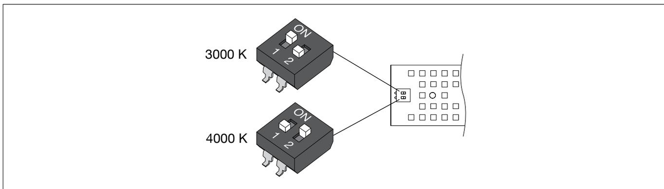
Die Farbtemperatur des LED-Moduls wurde werkseitig auf 3000 K eingestellt (Schalterstellung 1: "on", 2: "off"). Für Farbtemperatur 4000 K muss die Schalterstellung 1: "off" und 2: "on" gewählt werden.
