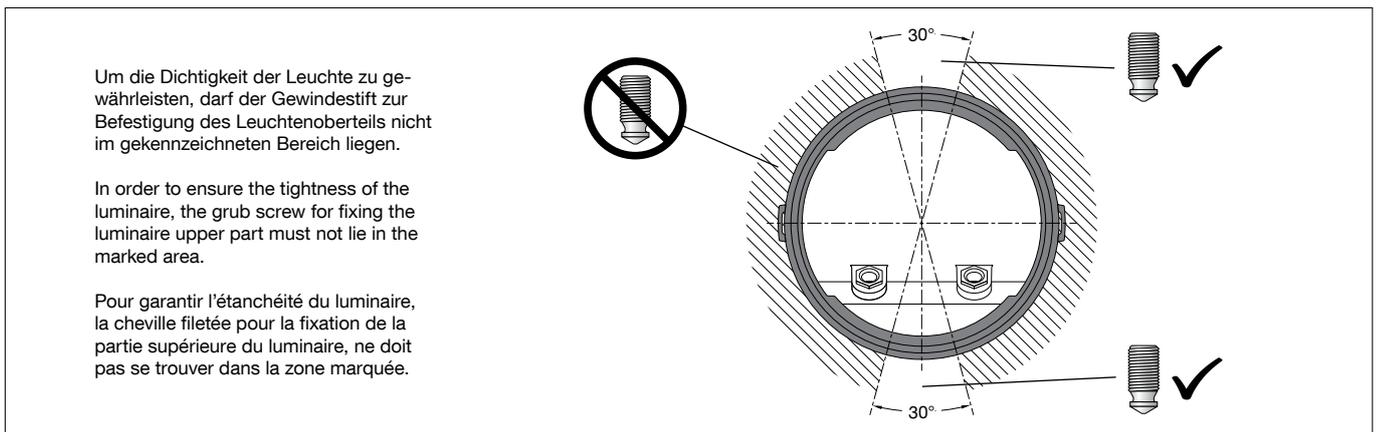
Um die Dichtigkeit der Leuchte zu gewährleisten, darf der Gewindestift zur Befestigung des Leuchtenoberteils nicht im gekennzeichneten Bereich liegen.
