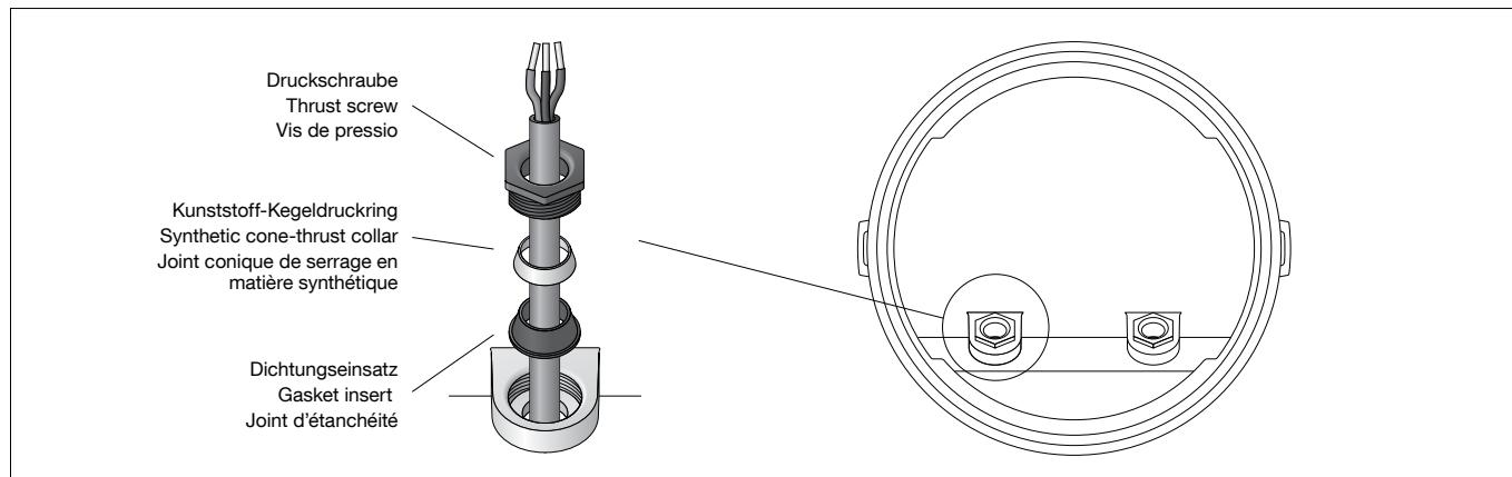
Das Leuchtenunterteil mit beiliegendem oder anderem geeigneten Befestigungsmaterial am Montagegrund befestigen. Leitungsschraubung fest anziehen. Schutzleiterverbindung herstellen und elektrischen Anschluss vornehmen.
