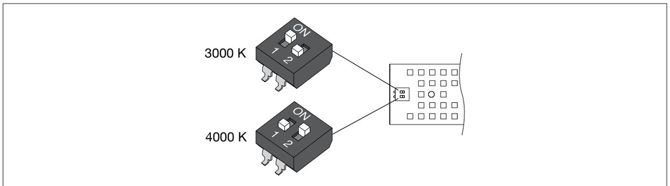
Die Farbtemperatur des LED-Moduls wurde werkseitig auf 3000 K eingestellt (Schalterstellung 1: "on", 2: "off"). Für Farbtemperatur 4000 K muss die Schalterstellung 1: "off" und 2: "on" gewählt werden.
