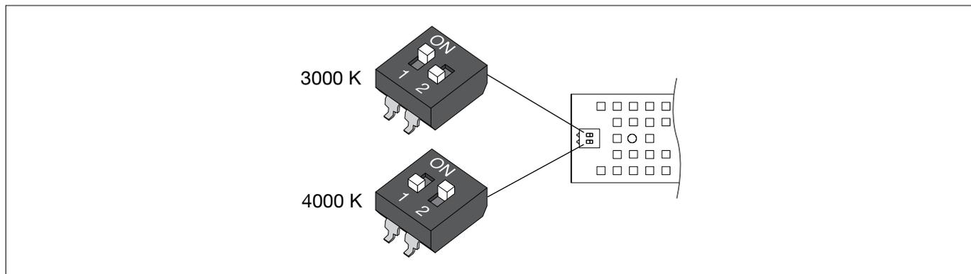
Die Farbtemperatur des LED-Moduls wurde werkseitig auf 3000 K eingestellt (Schalterstellung 1: "on", 2: "off").
