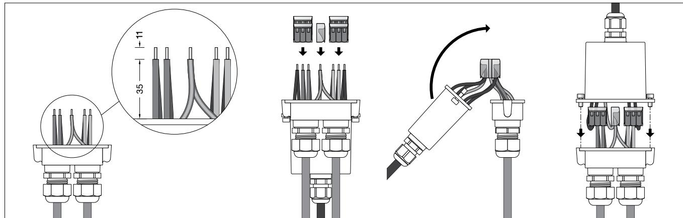
Elektrische Verbindung mit beiliegender Anschlussdose vornehmen (siehe Abbildung). Innensechskantschrauben (SW 3) lösen und Anschlussdose öffnen.
