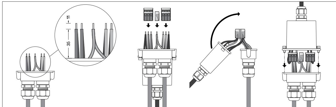
Elektrische Verbindung mit beiliegender Anschlussdose vornehmen (siehe Abbildung). Innensechskantschrauben lösen und Anschlussdose öffnen.
