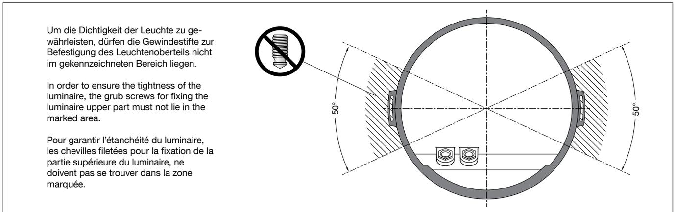
Um die Dichtigkeit der Leuchte zu gewährleisten, dürfen die Gewindestifte zur Befestigung des Leuchtenoberteils nicht im gekennzeichneten Bereich liegen.
