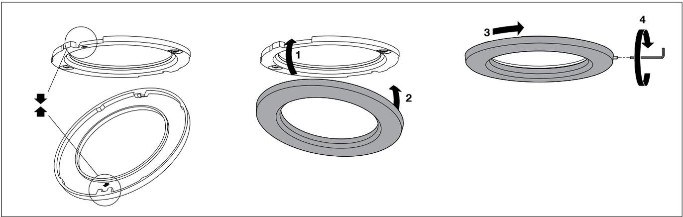
Beiliegenden Abschlussring (wie in der Skizze dargestellt) aufsetzen und rechtsherum drehen. Seitliche Sicherungsschraube (SW 1,5) eindrehen.
