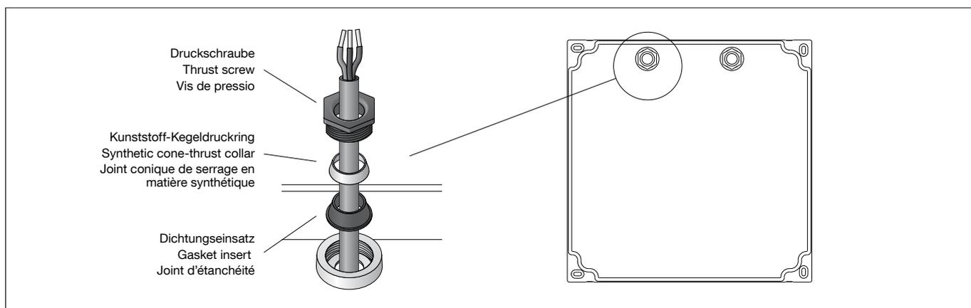
Das Leuchtenunterteil mit beiliegendem oder anderem geeigneten Befestigungsmaterial am Montagegrund befestigen. Leitungsver-schraubungen fest anziehen.
