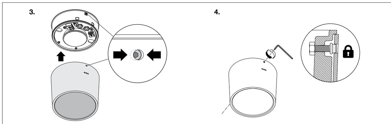
Auf richtigen Sitz der Dichtung achten. Leuchtgehäuse auf die Montageplatte führen und so positionieren, dass die beiden seitlichen Öffnungen mit den Innensechskantschrauben in der Montageplatte deckungsgleich liegen. Anschließend beide Innensechskantschrauben linksherum bis zum Anschlag herausdrehen.
