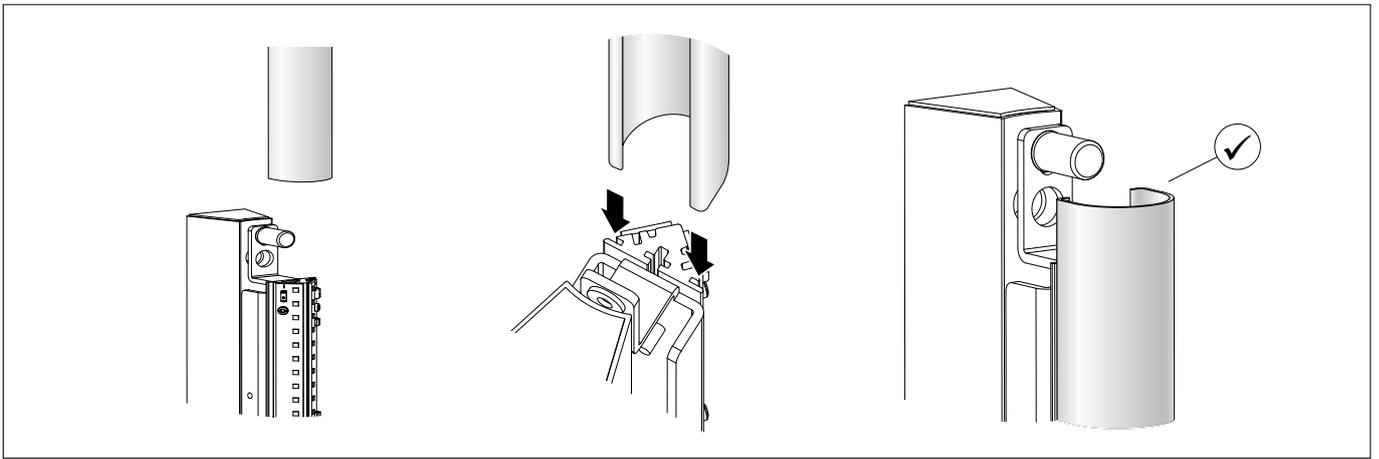
Kunststoffabdeckung bis zum Anschlag in LED-Tragprofil einschieben.
