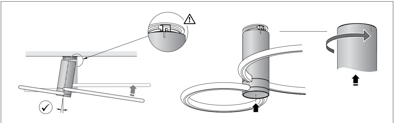
Leuchtengehäuse **in flachem Neigungswinkel** über den Befestigungsrand der Montageplatte aufsetzen und beischiwken.
