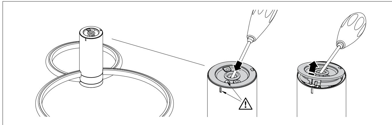
Zur Entnahme der Montageplatte aus dem Leuchtengehäuse, einen Schraubendreher schräg in die Dachführungsstüle einführen und dessen Spitze in Richtung der Außenmarkierung des Leuchtengehäuses positionieren.
