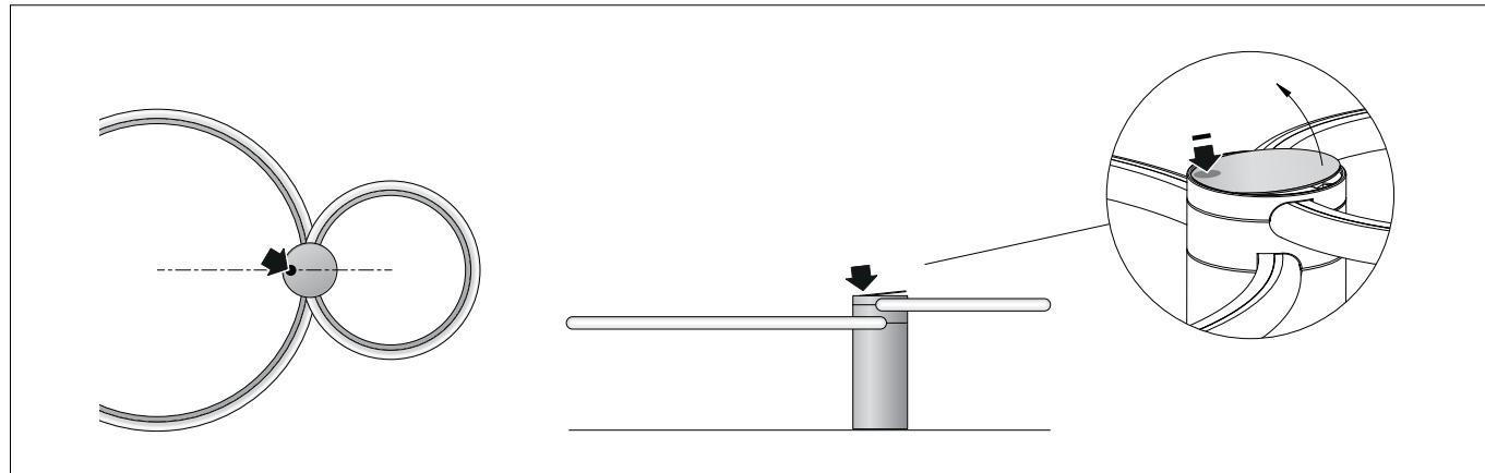
Die unterseitig eingelegte Metallrunde des Leuchtengehäuses durch leichten Druck im Randbereich aus der Gehäusenut lösen und entgegen der Magnettwirkung entfernen.
