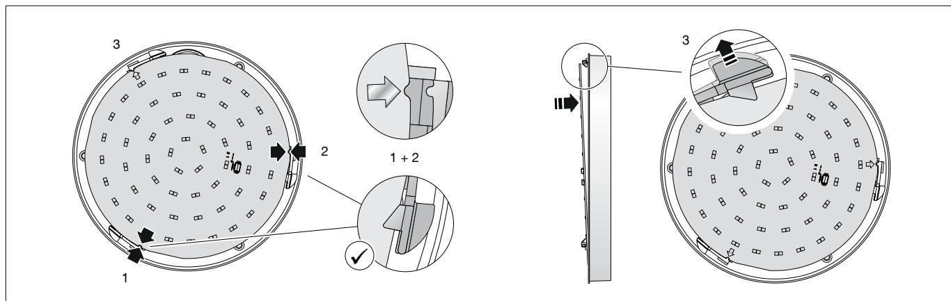
**HINWEIS:** Im Randbereich der LED-Platine sind 3 Aussparungen mit Pfeilen gekennzeichnet. Führen Sie die LED-Platine zunächst mit 2 dieser gekennzeichneten Aussparungen auf die passenden abgerundeten Positionsnasen der Haltefedern des Leuchtenunterteils. Bewegen Sie die dritte Haltefeder leicht nach außen, während Sie die LED-Platine in Position andrücken. Die LED-Platine wird so sicher in Endstellung gehalten.
