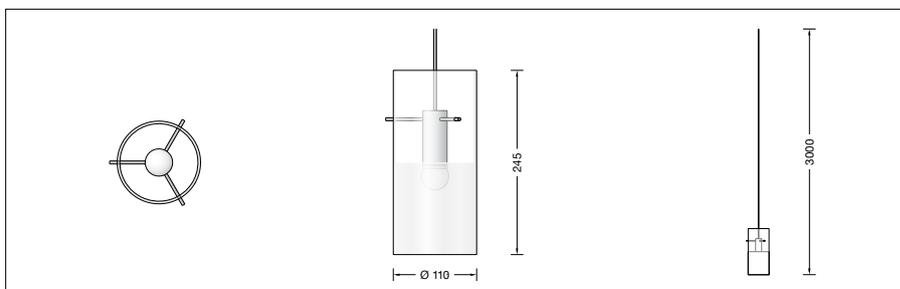
Für Aufbau- und Einbau-Stromschienensysteme
