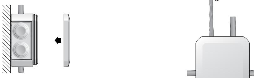
Bei aufrechter Montage der Verteilerdose erfolgt die Befüllung durch eine der oberen Kabeleinführungen.
