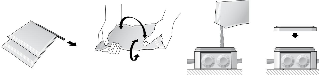
2-Komponenten-Gießharzbeutel aus der Verpackung nehmen und den Trennsteg zwischen den beiden Kammern entfernen. Beutelinhalt durch Kneten gut miteinander vermischen und anschließend in die Verteilerdosen füllen.
