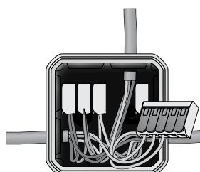
Verteilerdose öffnen. Anschlusskabel abmanteln und durch die Einstechdichtungen in die Verteilerdose führen.
