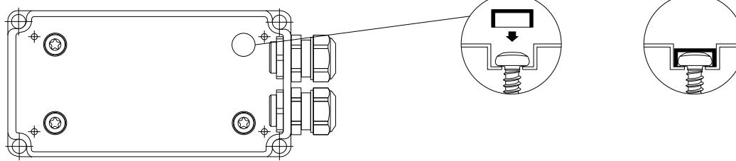
Für den Anschluss mehrerer Leuchten an das Netzteil wird eine zusätzliche Verbindungsdoce benötigt. Wir empfehlen hierzu die Verwendung der BEGA Verteilerdose **70 730**.
