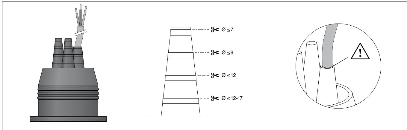
Zur Vorbereitung des elektrischen Anschlusses die kegelförmigen Leitungseinführungen, die tatsächlich benötigt werden, am oberen Ende entsprechend dem Durchmesser der bauseitig verwendeten Netzanschlussleitung öffnen.
