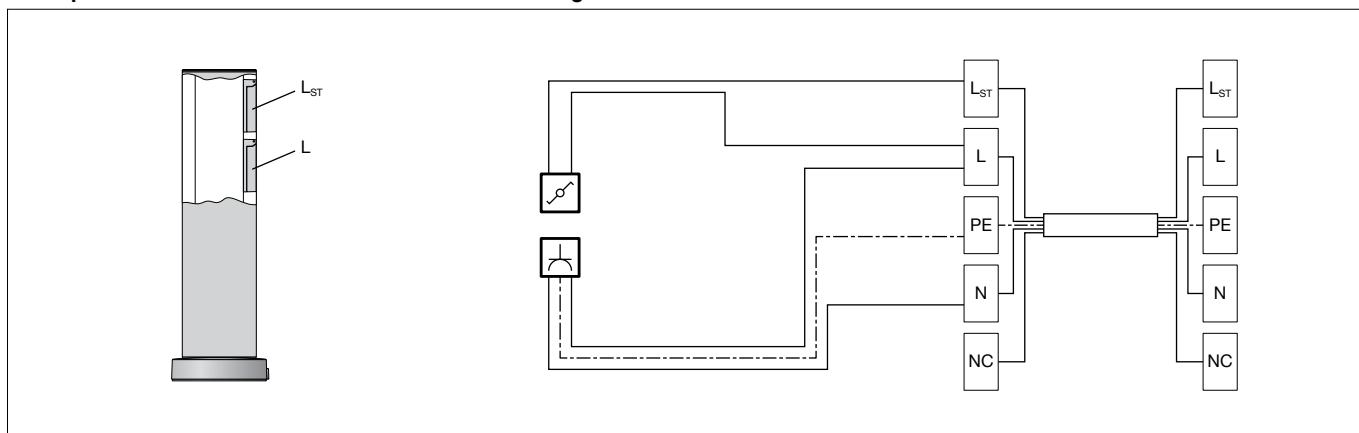
Elektrischen Anschluss an den Klemmen der Verbindungsleitung vornehmen.
