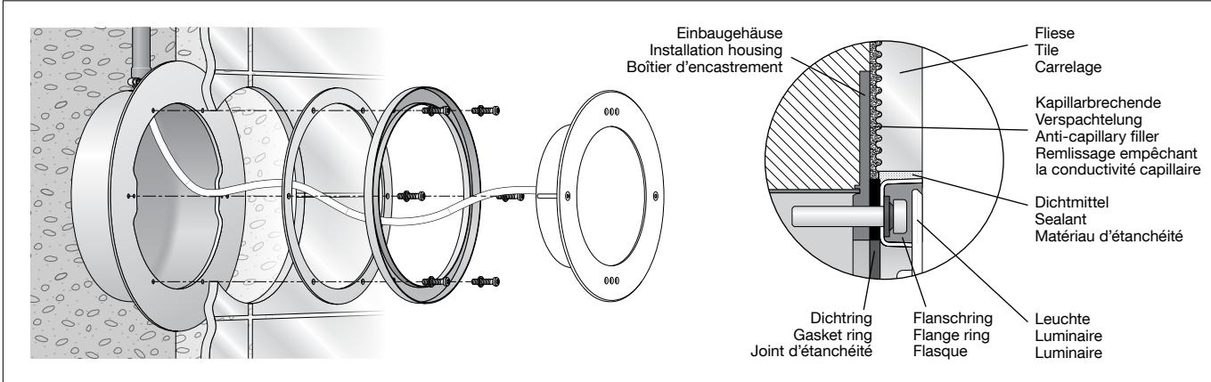
Nach dem Entfernen der Verschalung Schutzfolie vom Einbaugehäuse abziehen. Beiliegenden Flanschring und Dichtung gegen die Beckenwand setzen und mit den Zylinderschrauben (Torxantrieb T30) am Einbaugehäuse befestigen. Dabei unbedingt die beiliegenden Dichtringe verwenden. Zylinderschrauben über Kreuz gleichmäßig fest anziehen. Fliesen bündig bis an den Flanschring des Einbaugehäuses anbringen.
