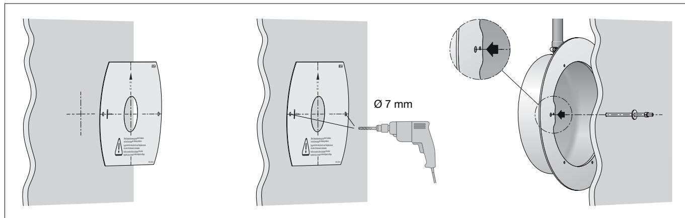
Die Befestigung des Einbaugehäuses an der Verschalung erfolgt mit den zwei beiliegenden Gewindestangen, Unterlegscheiben und Sechskantmuttern.
