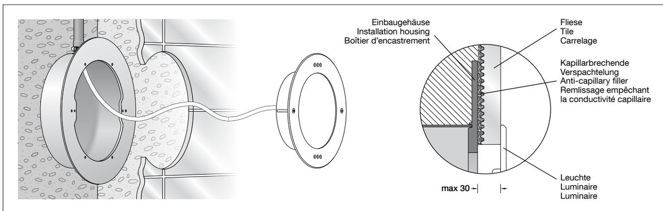
Nach Fertigstellen der Beckenarbeiten Schutzfolie vom Einbaugehäuse entfernen. Klebe-/Folienanstrich oder Fliesen bis zum Innendurchmesser des Einbaugehäuses anbringen.
