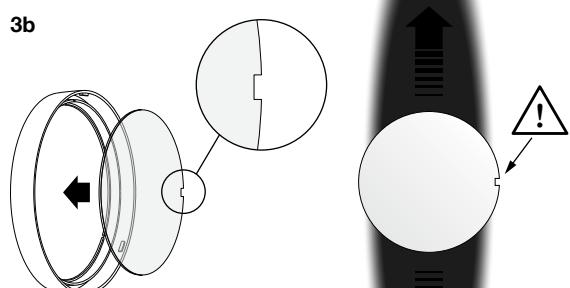
Optischen Filter mit der glatten Seite auf das Glas im Abschlussring legen und entsprechend der gewünschten Lichtstärkeverteilung ausrichten.
