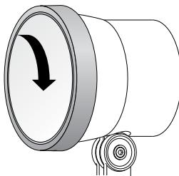
Abschlussring mit Glas und Reflektor so auf das Scheinwerfergehäuse aufsetzen, dass die Kerben im Abschlussring und Leuchtengehäuse übereinander liegen. Abschlussring rechtsherum bis zum Anschlag aufdrehen.
