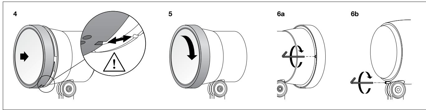
Abschlussring mit Glas und Reflektor so auf das Scheinwerfergehäuse aufsetzen, dass die Kerben im Abschlussring und Leuchtengehäuse übereinander liegen.
