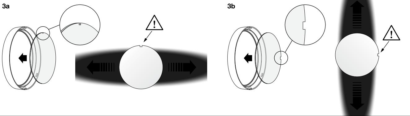
Optischen Filter mit der glatten Seite auf das Glas im Abschlussring legen und entsprechend der gewünschten Lichtstärkeverteilung ausrichten.
