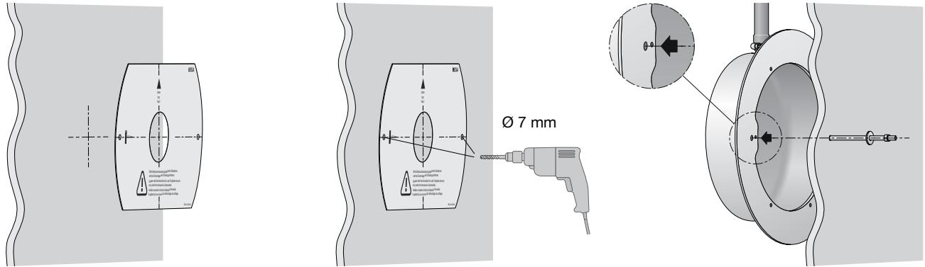
Die Befestigung des Einbaugehäuses an der Verschalung erfolgt mit den zwei beiliegenden Gewindestangen, Unterlegscheiben und Sechskantmuttern.
