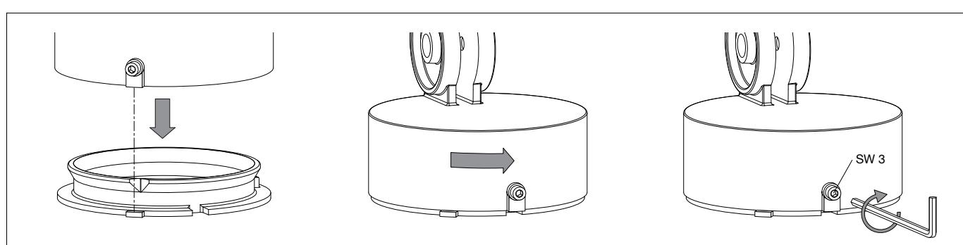
Scheinwerfer wie in Skizze dargestellt auf die Montageplatte setzen, ausrichten und fest verschrauben.
