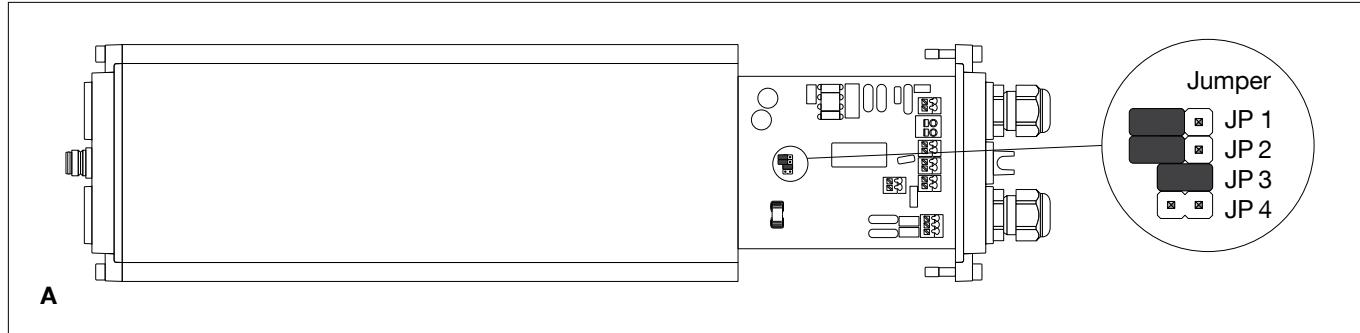
Die Betriebsart des Notstrommoduls wird über Steckbrücken (Jumper, siehe Abb. A) und einem 230V Schalt- / Tastersignal, dass im Anschlusskasten an der mit L' gekennzeichnetem Ader angeschlossen wird, gewählt.
