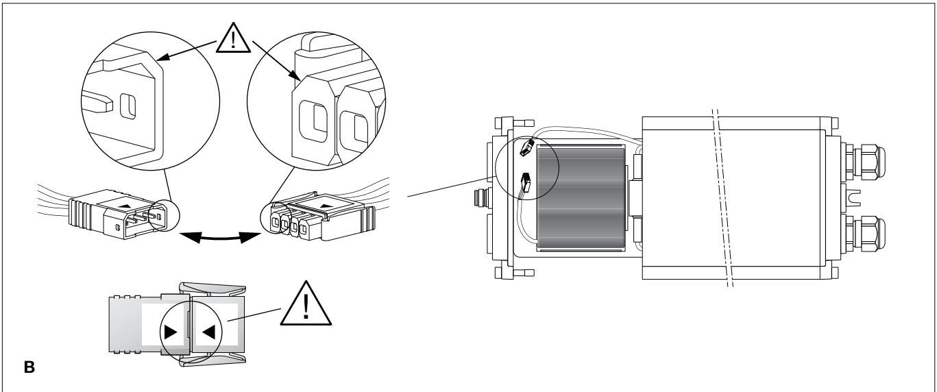
Platine in die Notstrombox einschieben und unteren Deckel montieren.
