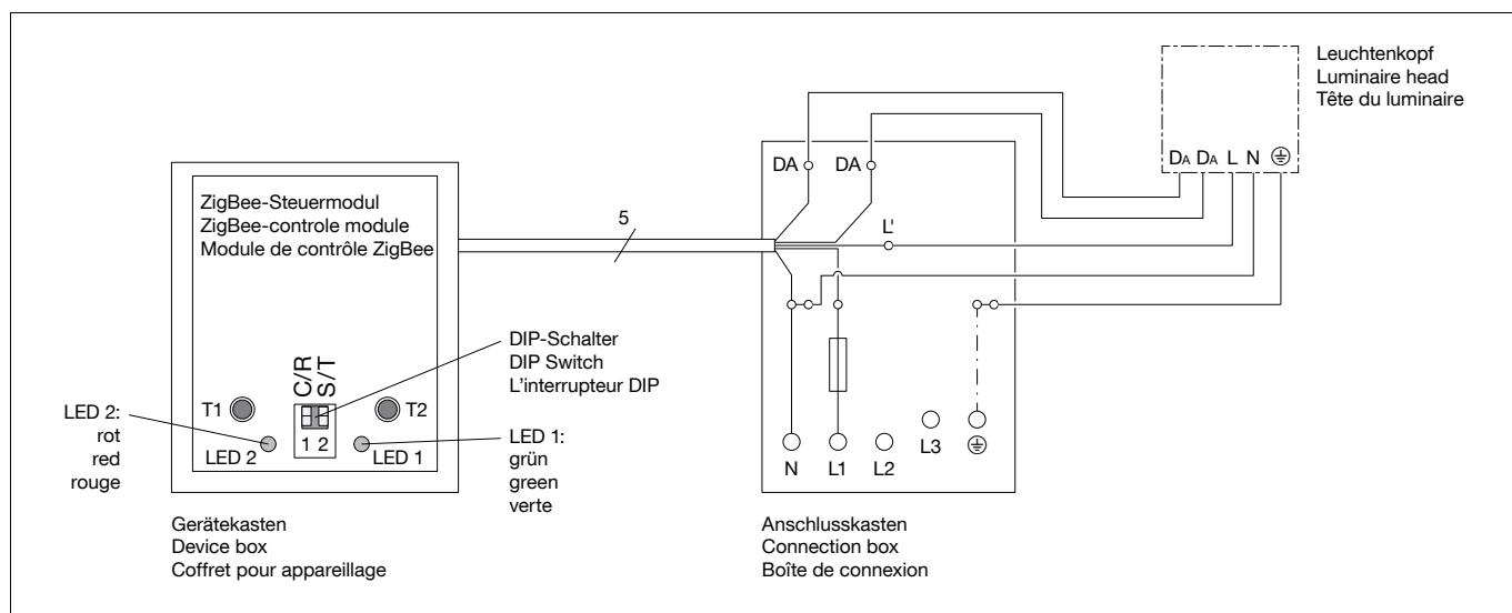
Gehäuse mit Steuermodul von der Montagetür demontieren (Innensechskantschraube SW 3). Bei der Inbetriebnahme kann eine eindeutige Zuordnung des Steuermoduls über die Seriennummer erfolgen, die auf dem Modul verklebt wurde. Für die bauseitige Dokumentation können die am Modul angehefteten Seriennummern-Etiketten verwendet werden. Hinweise zur Einstellung des Steuermoduls können dem Beileger entnommen werden.
