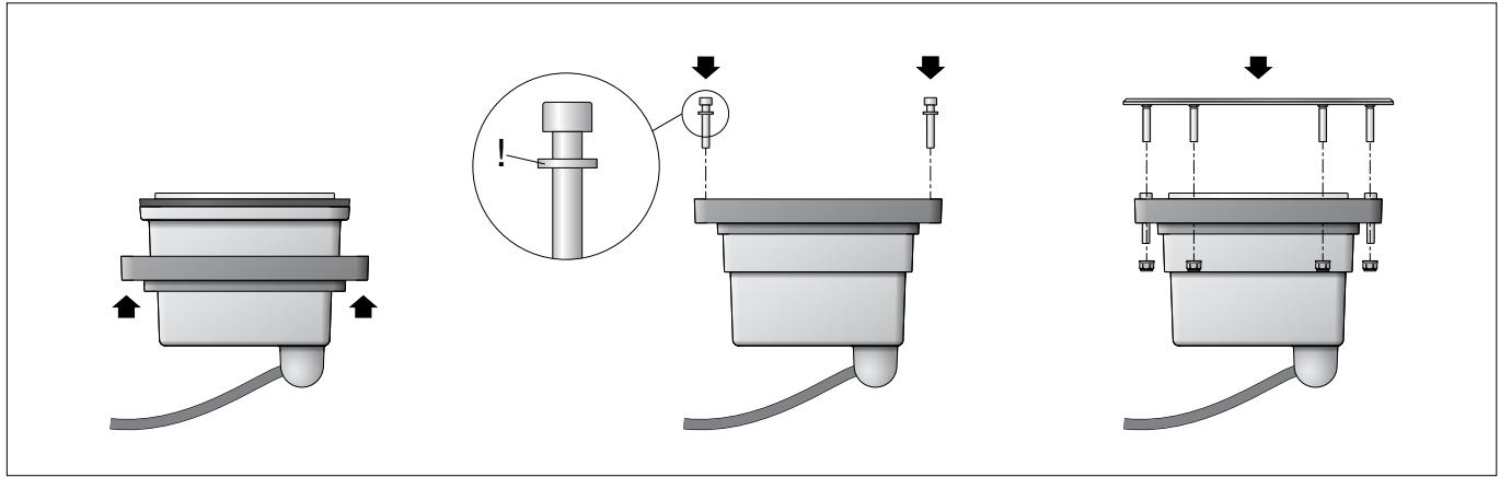
Schrauben im Edelstahlrahmen lösen und herausnehmen.
