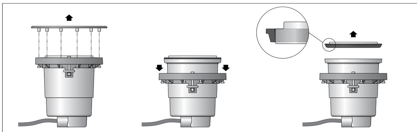
Leuchte aus dem Einbaugehäuse ausbauen. Dazu Schrauben im Edelstahlring bis zum Anschlag lösen.
