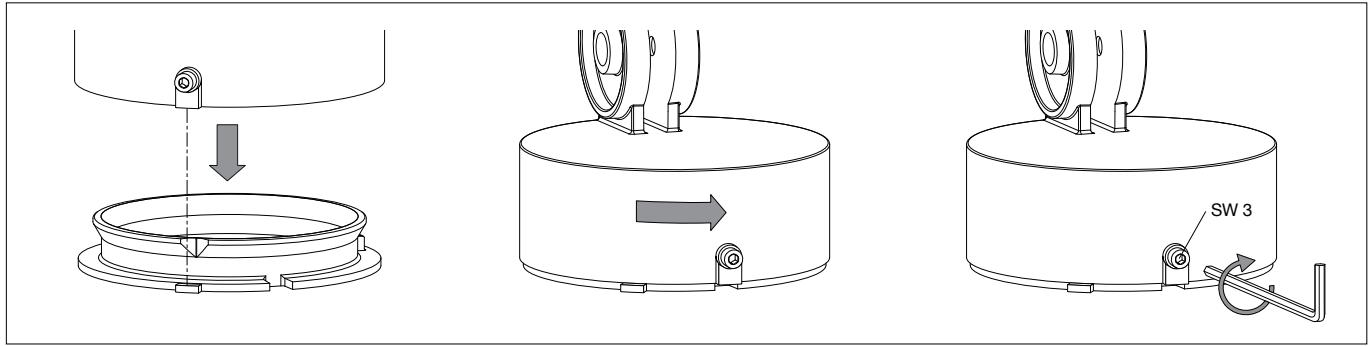
Scheinwerfer wie in der Skizze dargestellt auf die Montageplatte setzen, ausrichten und fest verschrauben.
