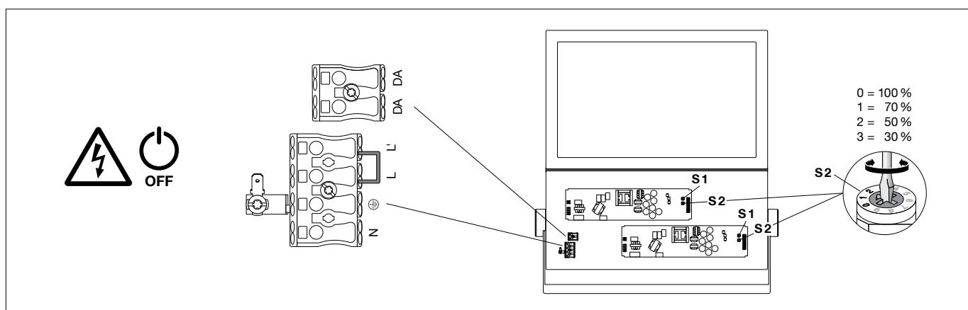
Schutzleiterverbindung zum Anschlussgehäuse herstellen – Steckverbindung – und Deckel auf das Anschlussgehäuse montieren. Dabei ist darauf zu achten, dass die Schutzleiterader nicht zwischen Deckel und Gehäuse eingeklemmt wird. Auf richtigen Sitz der Dichtung achten.
