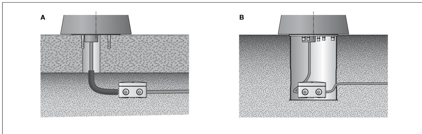
Montage auf einem bauseitig erstellten Fundament oder einer anderen befestigten Fläche (Abb. **A**):
