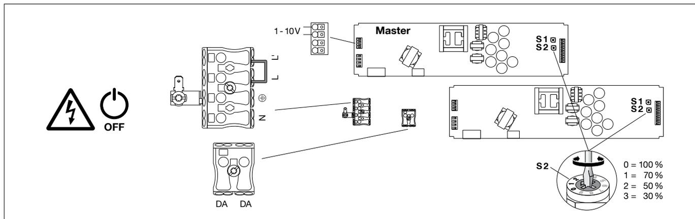
Schutzleiterverbindung zum Anschlussgehäuse herstellen – Steckverbindung – und Deckel auf das Anschlussgehäuse montieren. Dabei ist darauf zu achten, dass die Schutzleiterader nicht zwischen Deckel und Gehäuse eingeklemmt wird. Auf richtigen Sitz der Dichtung achten. Schrauben gleichmäßig fest anziehen. Anzugsdrehmoment = 1,5 Nm.
