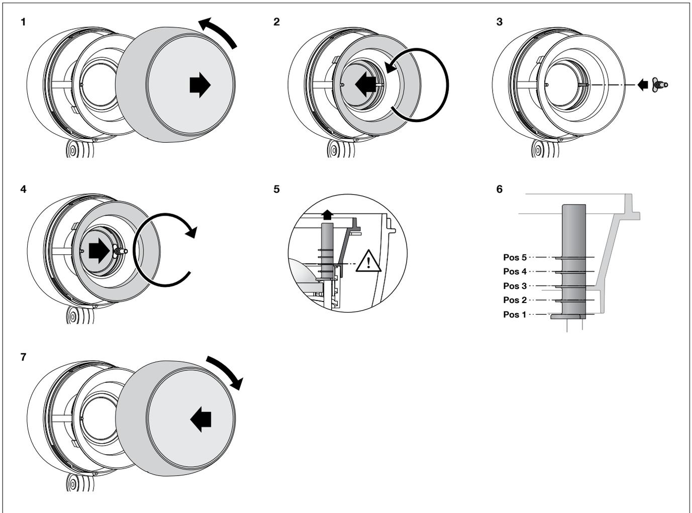
Abschlussring mit Sicherheitsglas durch Linksdrehung abnehmen.
