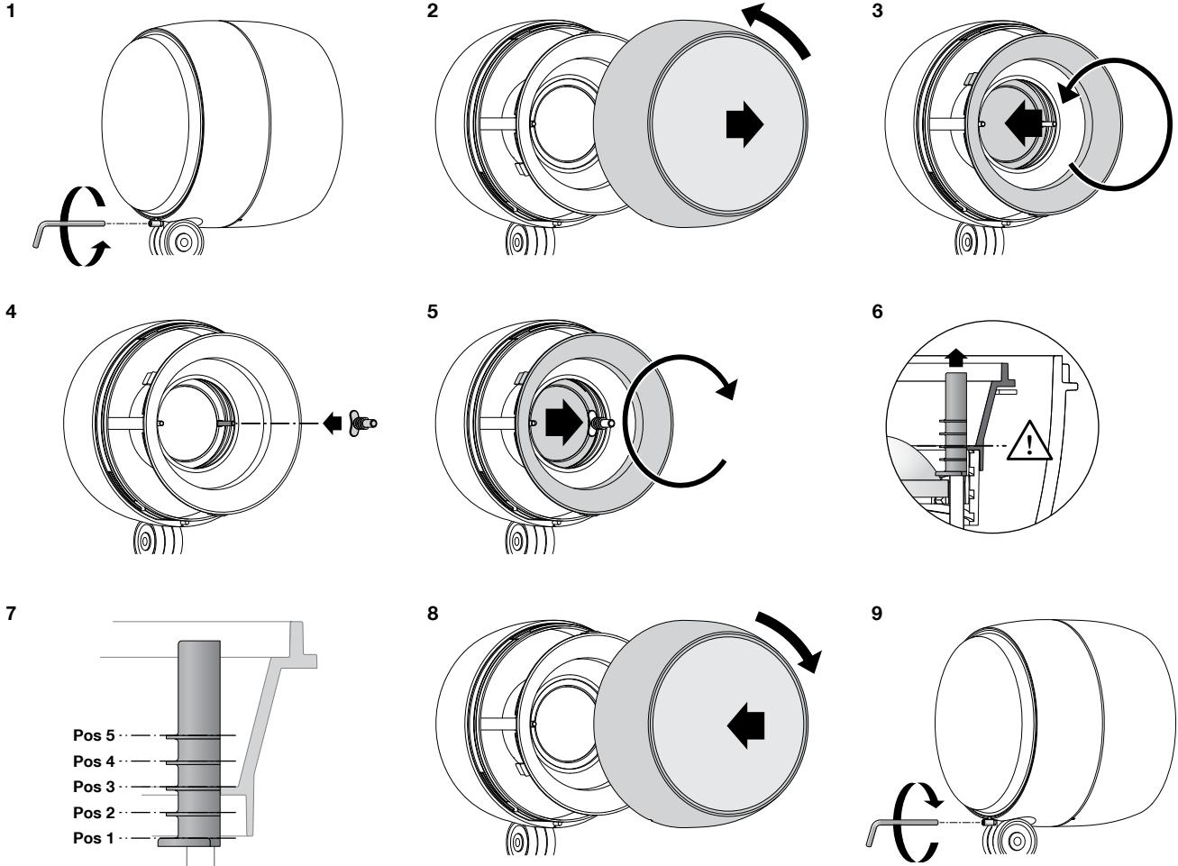
Verriegelungsstift (Innensechskant SW 2,5) auf der Rückseite im Scheinwerfergehäuse lösen. Abschlussring mit Sicherheitsglas durch Linksdrehung abnehmen.
