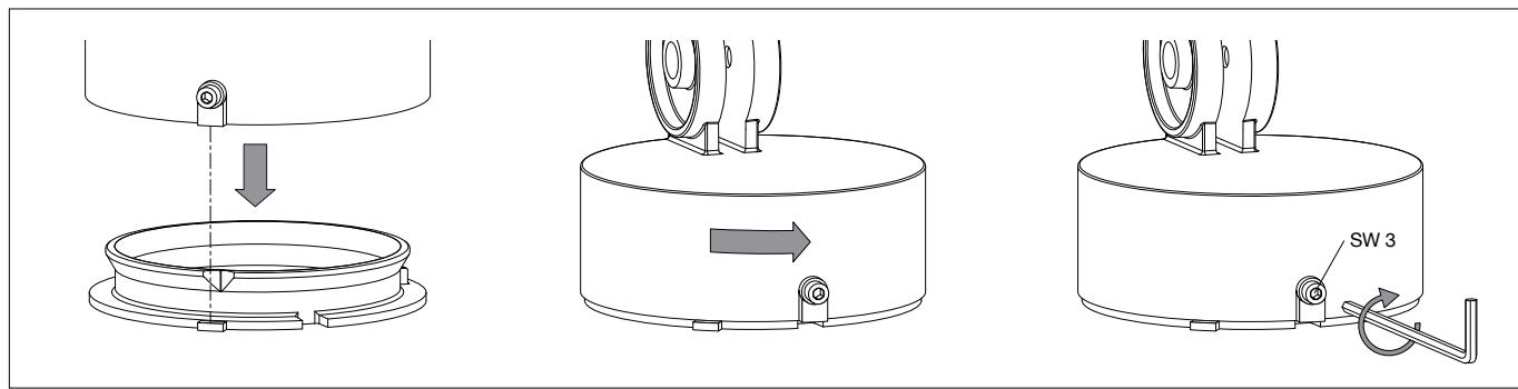
Scheinwerfer wie in der Skizze dargestellt auf die Montageplatte setzen, ausrichten und fest verschrauben.
