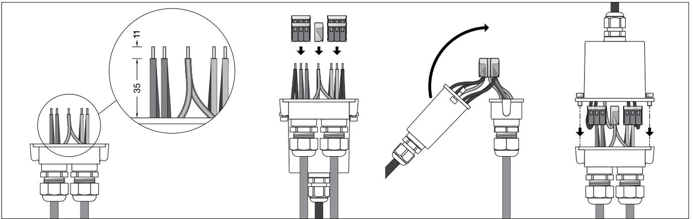
Elektrische Verbindung vornehmen (siehe Abbildung). Innensechskantschrauben lösen und Anschlussdose öffnen.
